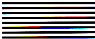
Abb. 3: Testfigur zur Sehschärfe: Die Striche haben eine Breite von 1 mm und einen Zwischenraum von ebenfalls 1 mm, der Abstand der Striche beträgt also 2 mm
